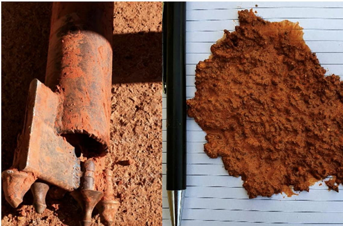
**FIGURA 3** - BITTER DE 8 POLEGADAS DE DIÂMETRO UTILIZADO NO MÉTODO ROTO-PNEUMÁTICO. À DIREITA, SAPROLITO DE QUARTZITO MÉDIO A GROSSO DA FORMAÇÃO RIBEIRÃO PIÇARRÃO
