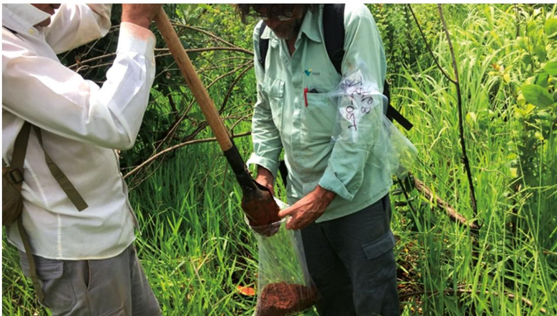
**FIGURA 44** – AMOSTRAGEM DE SOLO EM PROFUNDIDADE DE 60 CM COM AUXÍLIO DE TRADO MANUAL
