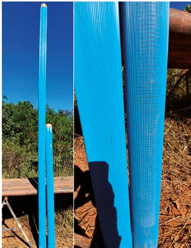
**FIGURA 6** - PAR DE CAPS QUE VEDAM AS DUAS EXTREMIDADES DOS CONJUNTOS DE REVESTIMENTO
