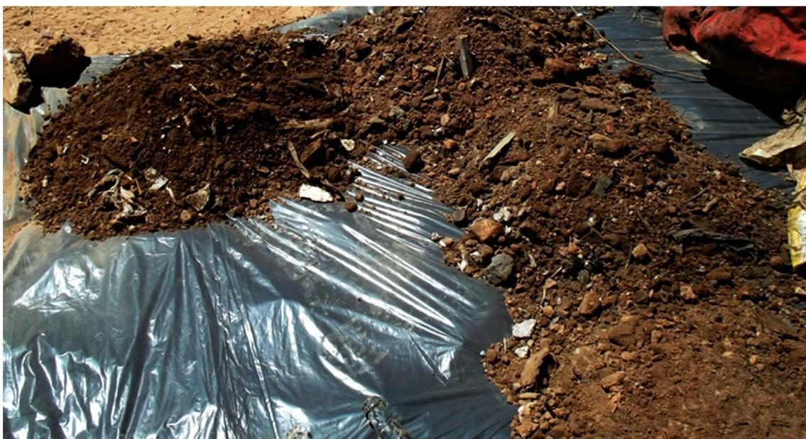
**FIGURA 64** – MADEIRA RETIRADA DA ESCAVAÇÃO DA AMOSTRA GRA - 04. PREDOMINÂNCIA DE MADEIRA UTILIZADA EM OBRAS (TÁBUAS E TARUGOS)
