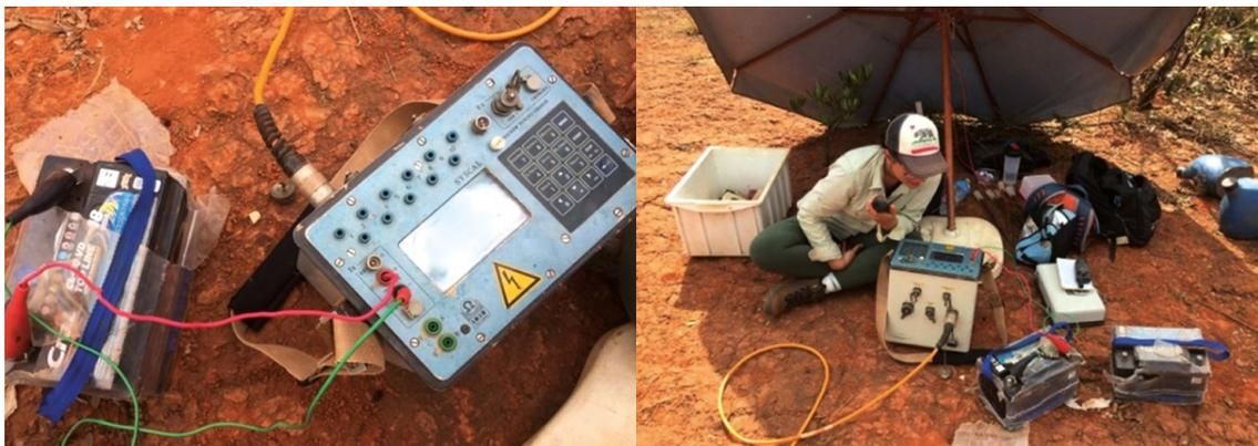
Na Tabela 5 estão listadas as coordenadas do início e do fim de cada seção levantada na área do Lixão e adjacências, onde foram executados 28 perfis de levantamentos geofísicos (sendo 15 de 240 metros de extensão e 13 de 360 metros, totalizando 8.280 metros lineares de seções de tomografia elétrica).
