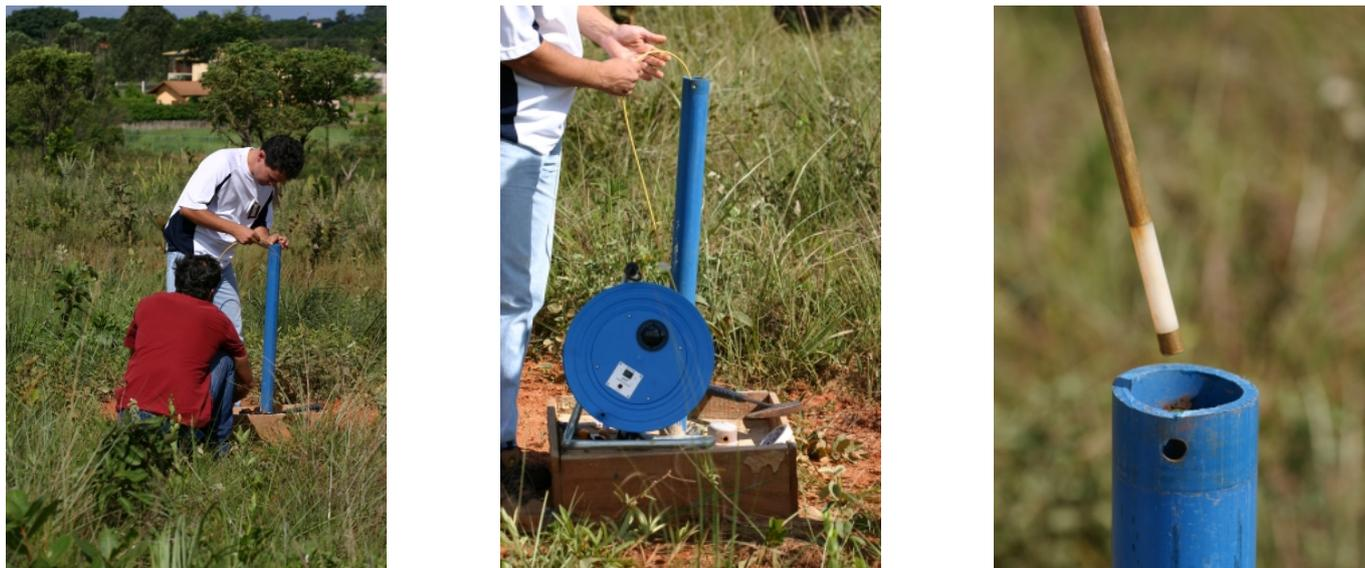
**Figura 2** - Procedimento e equipamento utilizado para medição de nível freático.
